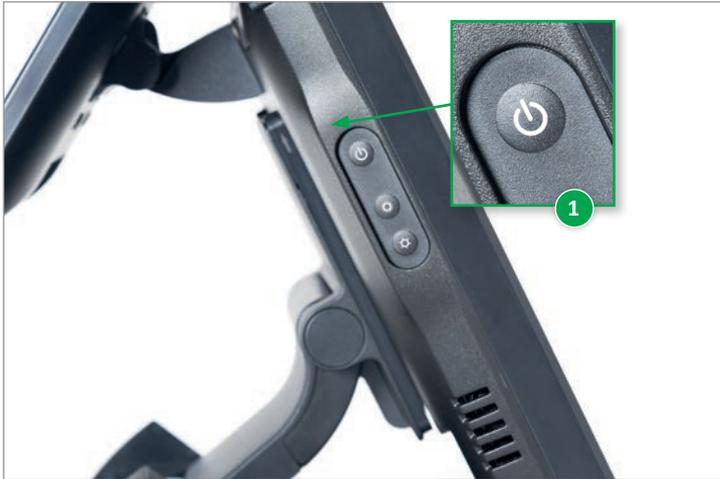
Am Kassenmonitor wird über den An- und Aus-Schalter **1** das gesamte System ein- und ausgeschaltet.
